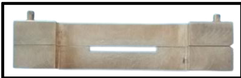
Fig. (3). Metal mold (25x2x2 mm 3 ).
